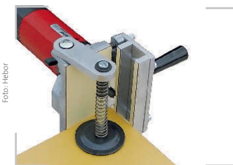
/ Mit dem Vorsatz der Hebor-Kantenfräse- und -Kappmaschine lassen sich Stirnkanten präzise bearbeiten.
