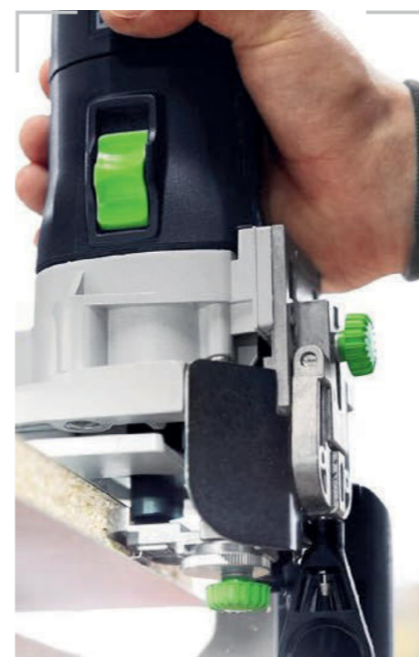
/ Ein verschiebbarer Tastschuh ermöglicht die vollständige Nutzung der Fräuserschneide bei Festool.
