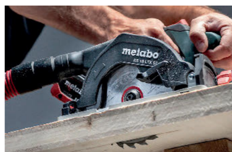
/ Die Akku-Handkreissäge KS 18 LTX 57 von Metabo schafft eine Schnitttiefe von 57 mm.
