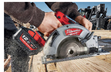
Mit dem dreireihigen 18-Volt-Akku schneidet die Milwaukee M18 FCS66 FUEL 66 mm dicke Bohlen.
