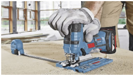
/ Mit Kreisschneidern (Zubehör) sollen Stichsägen auch runde Ausschnitte erstellen können. (Foto: Bosch)
