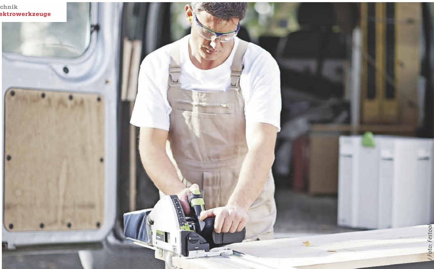
/ Lläuft mit einem oder zwei 18-V-Akkupacks: Die Festool TSC 55 REB lässt sich zudem gut auf der Führungsschiene einsetzen.
