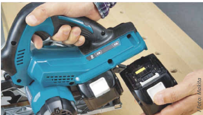
/ Nimm zwei: Auch Makita setzt auf das Doppelakku-Konzept. Hier müssen allerdings immer beide Akkus eingeschoben werden.
