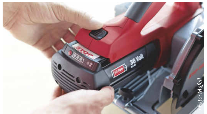
/ Kompatibel hergestellt: Der große 36-V-Akkupack von Mafell stammt von Bosch und kann in den 36-V-Geräten von Bosch verwendet werden.
