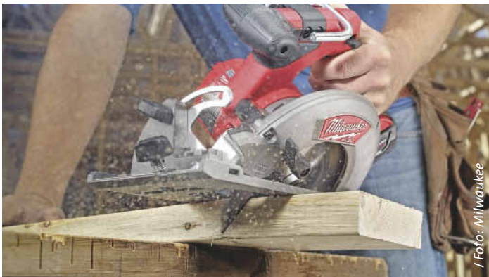
/ Am Markt sind zwei verschiedene Bauweisen vertreten. Bei der Milwaukee M18 CC befindet sich das Sägeblatt, wie in Amerika üblich, auf der linken Maschinenseite.
