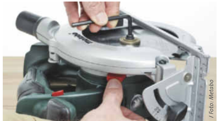
/ Die integrierte Spindelarrretierung ermöglicht einen einfacheren Sägeblattwechsel. Dieses Feature hat sich heute fast schon als Standard durchgesetzt.
