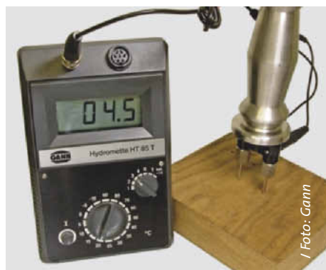
/ Bei Profigeräten kann die variierende Dichte unterschiedlicher Holzarten exakt eingestellt werden.
