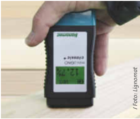
/ Holzfeuchtemessung im handlichen Taschenformat: hier ein Gerät mit Einstech-Elektroden
