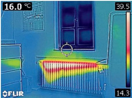
/ ... IR-Bild, verbessern Kontrast und Orientierung im Foto (Vgl. zeigt IR-Auflösung 80 x 60, ohne/mit „MSX“).
