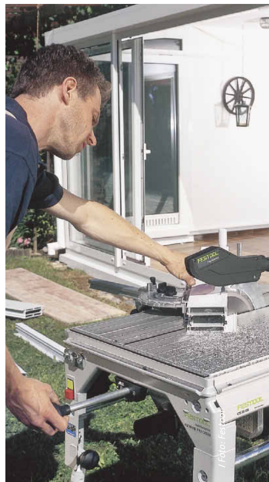
/ Exaktes Ablängen langer Teile ermöglicht die Unterflurzugsäge durch das hervorziehbare Sägeblatt.
