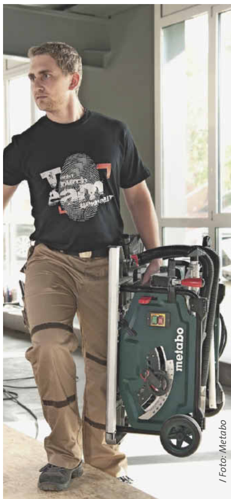
/ Maschinen, die unter 35 kg wiegen, lassen sich von einer Person durch die Baustelle tragen.
