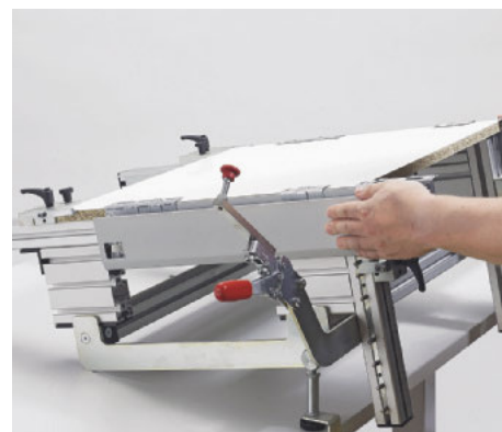
/ Einfache Spannhebel und ein Aluminiumrahmen fixieren die Teile bei der Montagehilfe „Arcifit 200“.
