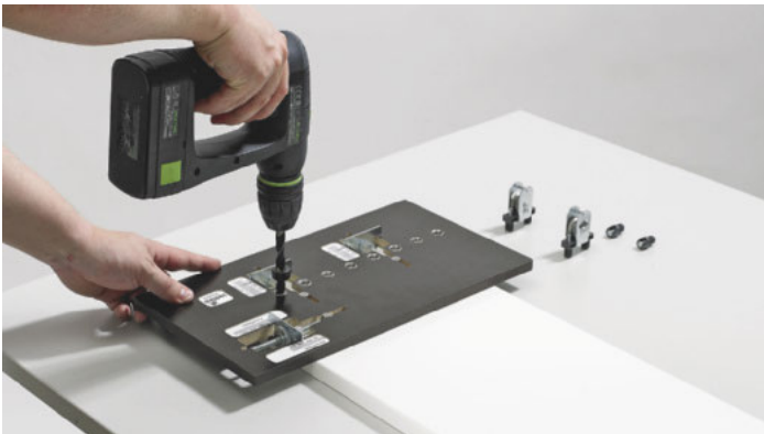
/ Garantiert präziser Sitz: Mit der Bohrlehre „Practica 200“ werden die Bohrungen für die Frontbefestigung von Arcitech- und Innotech-Schubkästen gebohrt und ...
