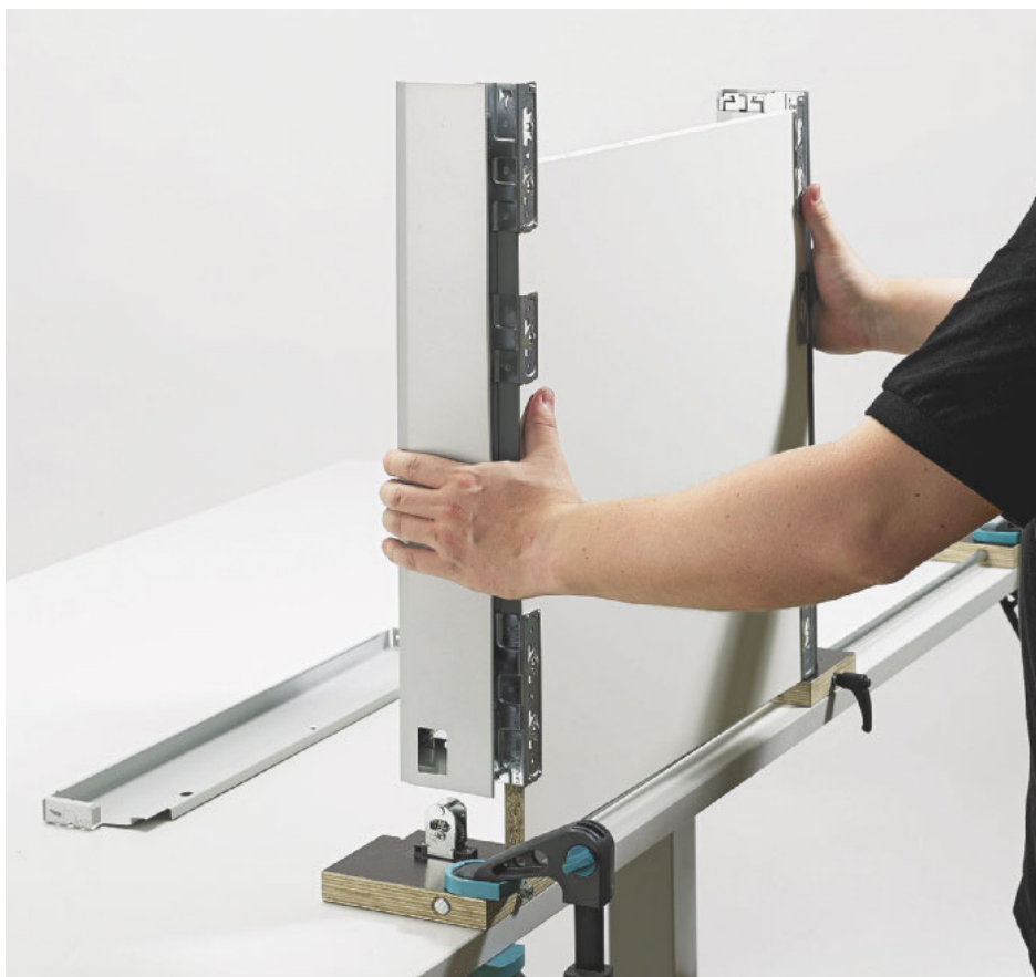
/ Einfach und effizient: Mit dem Einsteigermodell „Arcifit 100“ von Hettich lassen sich bis zu 15 Schubkästen in der Stunde montieren.
