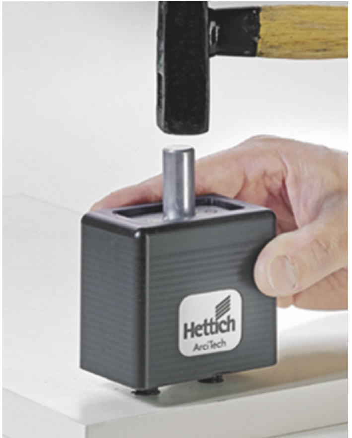
/ ... anschließend mit einem speziellen Einschlagwerkzeug sauber eingesetzt.
